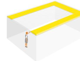
**Extra Bass** es un absorbente de frecuencias bajas único, tiene un grosor de 50mm y ha sido especialmente diseñado para colocarlo por encima del techo. Absorbe el molesto ruido de fondo. Extra Bass debería cubrir por lo menos el 50% de la superficie del techo.
