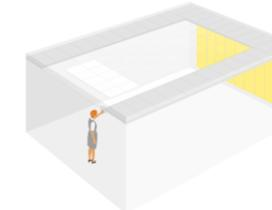
**Akusto Wall** absorbe el sonido que si no, rebotaría de las paredes, creando ecos. En un entorno de enseñanza tradicional, Akusto Wall debería instalarse en la pared posterior y para trabajar en grupos, en dos paredes adyacentes.
