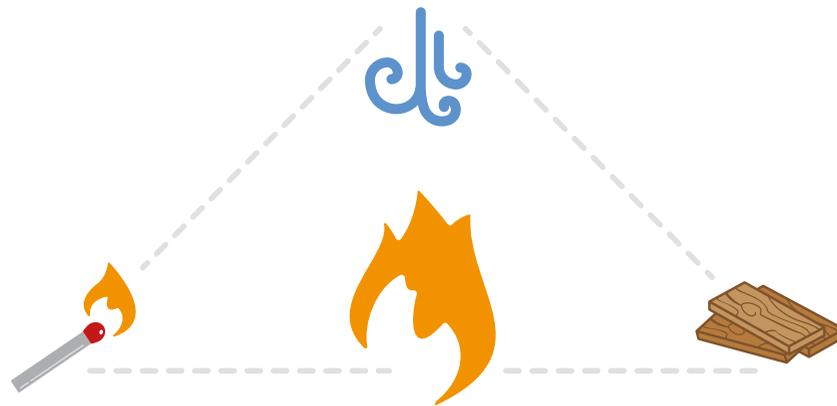
El fuego es una reacción química que necesita la presencia de combustible, comburente y una fuente de calor.
