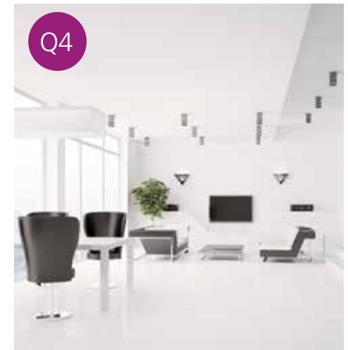
Es la terminación óptima, de máxima calidad, que minimiza la posibilidad de que se produzcan contrastes en la superficie y las juntas. Esta especialmente indicada para revestimientos lisos o brillantes, barnices o revestimientos de brillo medio y técnicas de estuco u otras técnicas de enlucidos alisados.
