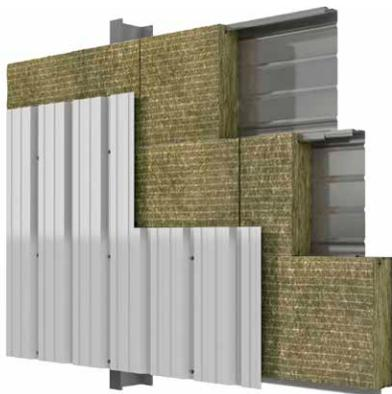
Las **fijaciones** de la piel exterior, apoyadas directamente sobre el aislamiento, deben ser siempre de tipo **autotaladrante de doble rosca, con arandela de estanqueidad y longitud adaptada al espesor del panel** para la rotura del puente térmico del solape de las bandejas (tornillo de 70 mm para una rotura de 40 mm).
