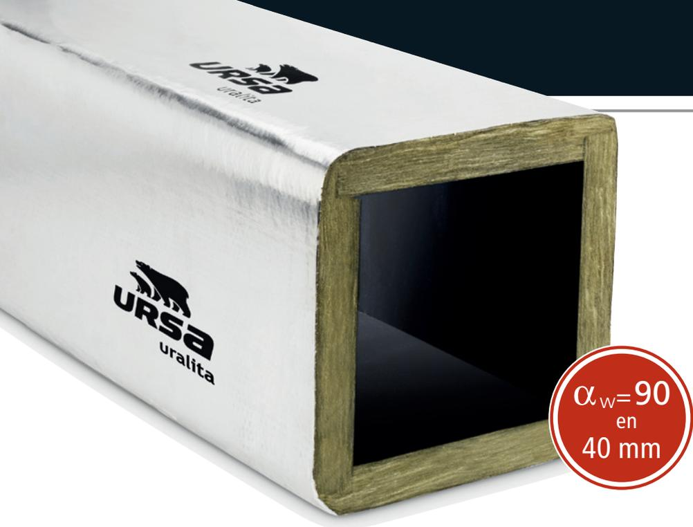
**URSA AIR Zero Q4** es un panel de lana mineral, revestido por su cara exterior por un complejo kraft-aluminio reforzado, y por su cara interior por el tejido acústico de color negro Zero.
